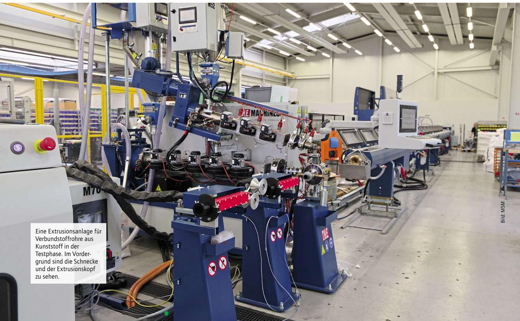
Eine Extrusionsanlage für Verbundstoffrohre aus Kunststoff in der Testphase. Im Vordergrund sind die Schnecke und der Extrusionskopf zu sehen.
