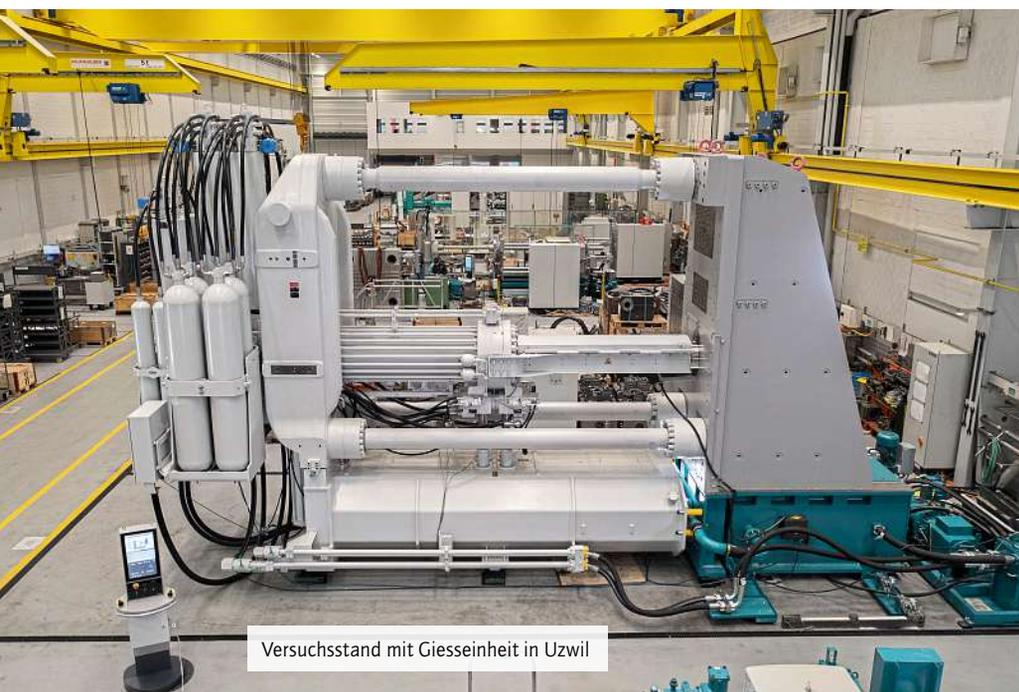
Versuchsstand mit Giesseinheit in Uzwil
